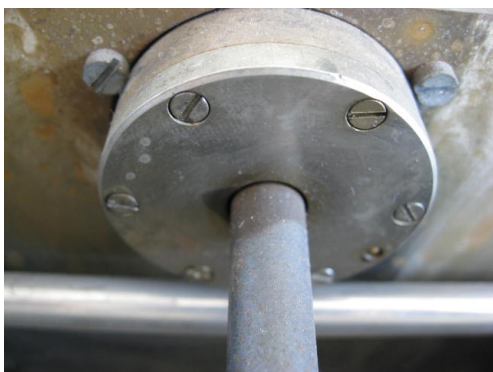
Фигура 20. Рубеновата клапа на олфактометъра – А. поглед от вън и Б. от вътре. Към шестия отвор липсва тръбичка, понеже не използвахме хлороформ
