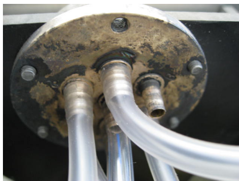
Фигура 20. Рубеновата клапа на олфактометъра – А. поглед от вън и Б. от вътре. Към шестия отвор липсва тръбичка, понеже не използвахме хлороформ
